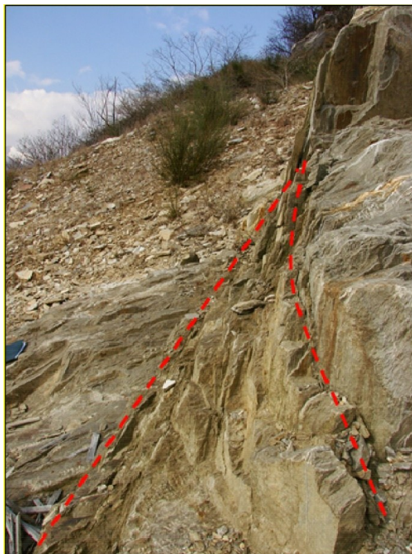
FIGURA 11: IMMAGINI FOTOGRAFICHE DI SETTORI DI AMMASSO ROCCIOSO CON DEFORMAZIONE DI TIPO DISGIUNTIVO
